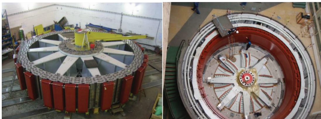
Slika 4. Rotor i stator sinhronog generatora na kojem su vršeni eksperimenti
