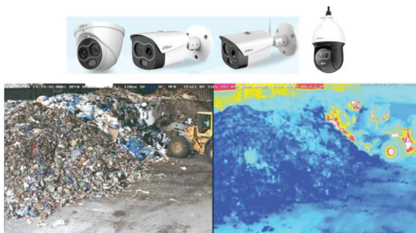
Slika 3. Detekcija vrućih površina pomoću termalne kamere
