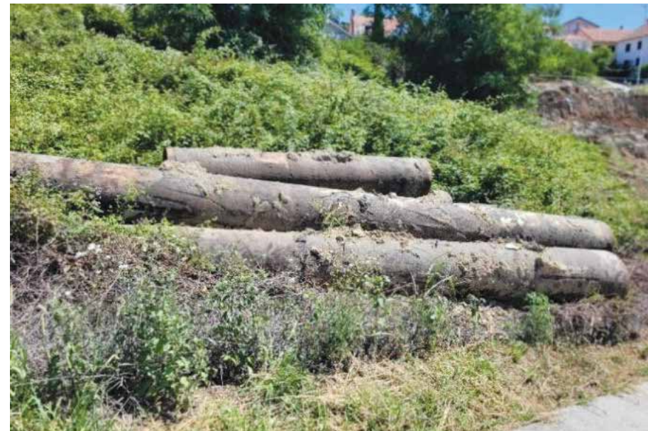
Stare cijevi DN 600mm, odložene nakon vađenja, foto: O. Doklešić
