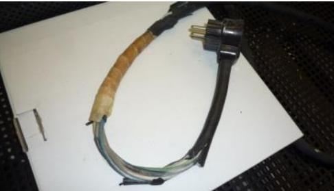
Elektroinstalacione komponente (primer – šuko-utičnice) sa oštećenom (polomljenom) PVC maskom – omogućen direktni dodir delova instalacije pod naponom, ili oštećena električna izolacija napojnih kablova prijemnika [8]
