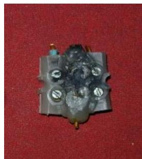
Termičko oštećenje PVC izolacije faznog provodnika usled porasta temperature na lošem električnom kontaktu (redna klema) [9,10]
